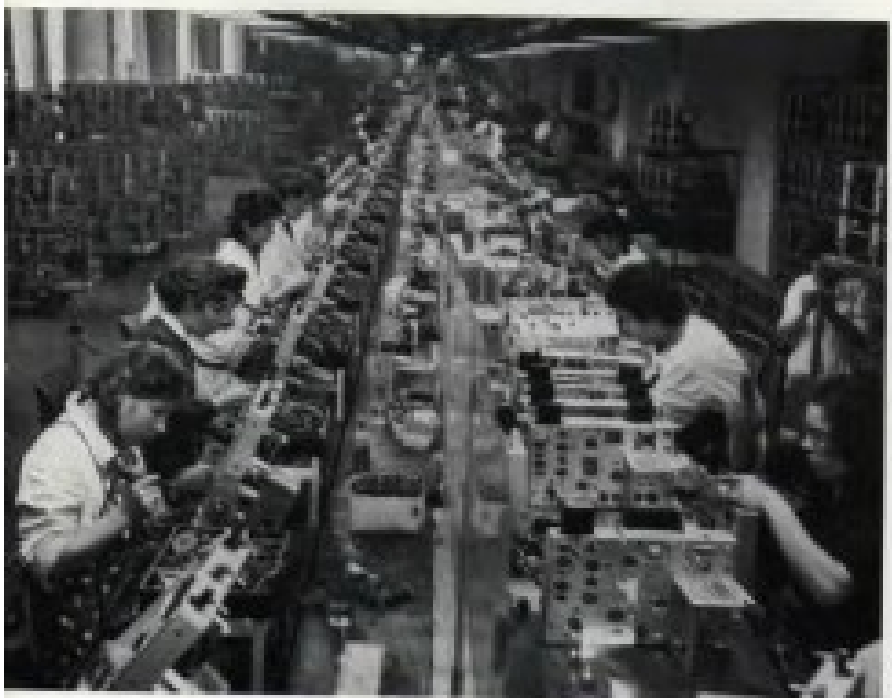
Műgő telelési szerelvények 1962. A szalagokon az AT403 és AT503 tv. készülékek mechanikus szerelése látható
